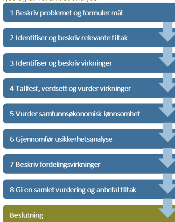
Figur 1.1 Flytdiagram for samfunnsøkonomiske analyse og en forenklet analyse
